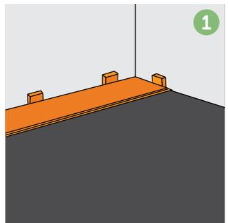
Benutzen Sie ausreichend Holzkeile, um die Dehnungsfuge während der Verlegung zu fixieren. Es ist zu empfehlen, die Dielen längs zum Hauptlichteinfall zu verlegen, in länglichen, schmalen Räumen ist immer eine längsseitige Verlegerichtung empfehlenswert. Ferner sollten Sie an einer geraden Wand des Raumes beginnen.
